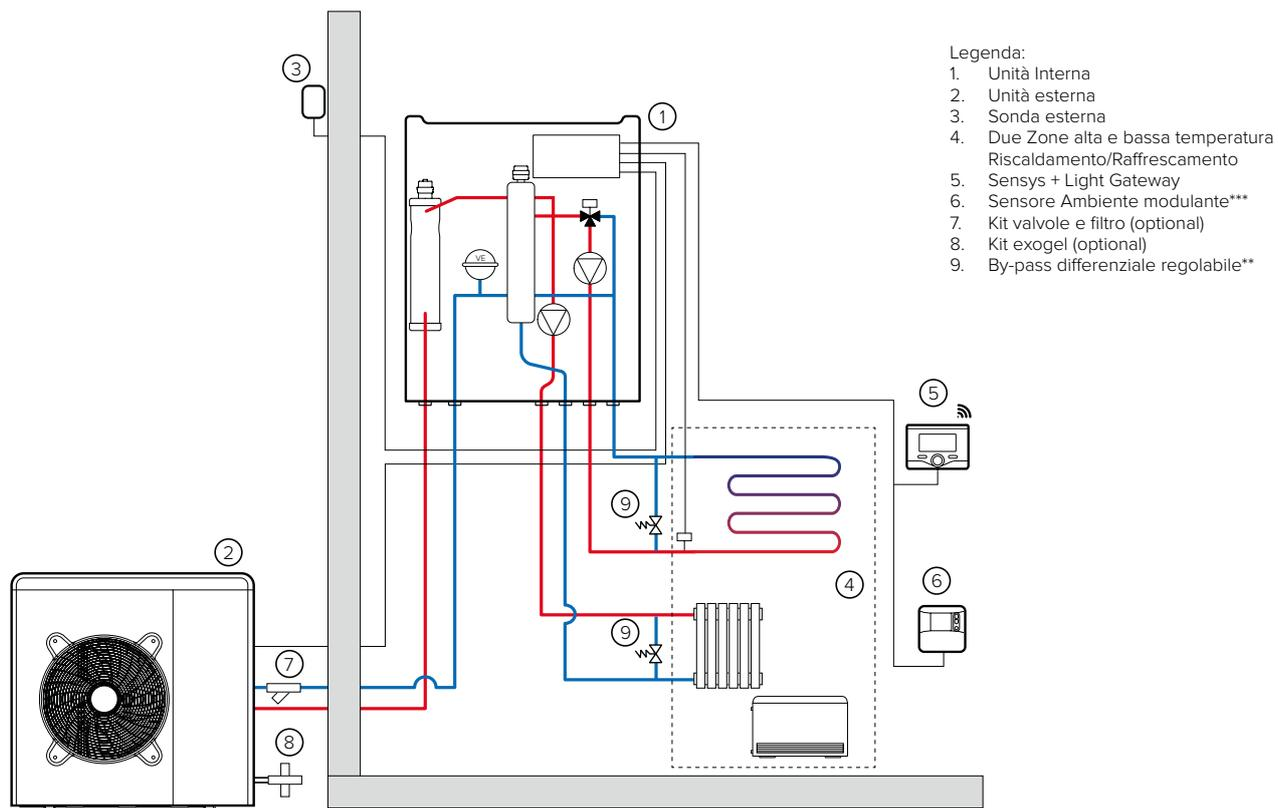
\*\*\* per la gestione della seconda zona tramite ARISTON NET, è necessario installare un'ulteriore Sensys al posto del sensore ambiente modulante.
